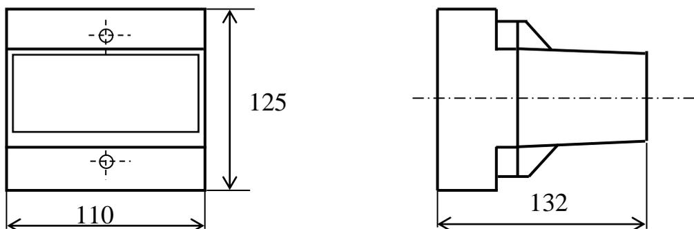
Рисунок А.1 – Габаритные размеры ИП
