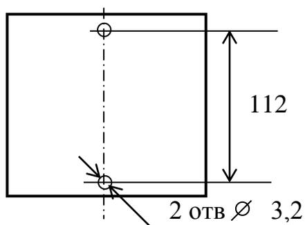
Рисунок А.2 – Установочные размеры ИП
